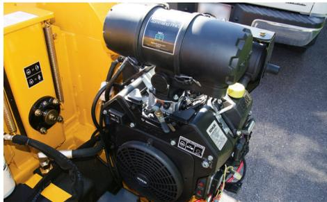
**MOTOR EFI DE 25HP (18.6 KW)** Mantiene un buen desempeño en climas de extremo frío, reduciendo la posibilidad de un ahogamiento del motor, favoreciendo también en un ahorro de combustible.
