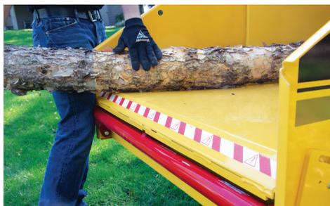
**BOTON DE PARO DE ALIMENTACION** Estratégicamente localizado a la altura de la pierna del operador, ya que al golpearla directamente se apagará el rodillo alimentador, ya sea intencional o automáticamente en caso de una emergencia, incrementando así la seguridad durante la alimentación de la astilladora.
