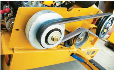
**EMBRAGUE CENTRÍFUGO** El embrague centrífugo previene el movimiento de la banda cuando se engancha, evitando altos costos de mantenimiento.
