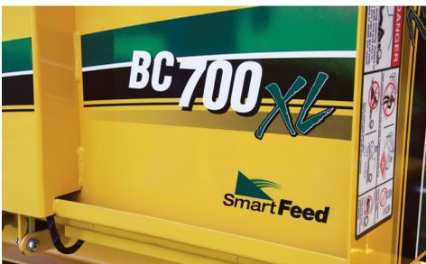
**SMARTFEED.** El sistema SmartFeed patentado ayuda a aumentar la productividad del operador a la vez que reduce la deformación de las piezas vitales del motor. El sistema de control de la detección de alimentación monitorea las rpm del motor y automáticamente detiene e invierte los rodillos de alimentación al suministrarse materiales más grandes de madera dura.
